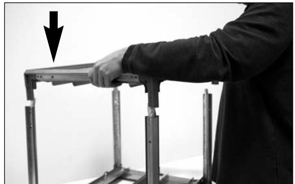
8. Une fois que le système est disposé dans son nouvel emplacement, réinstallez le châssis supérieur sur le châssis inférieur.
