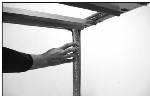
2. Remplacez les bandes d'isolant dans les rainures.
