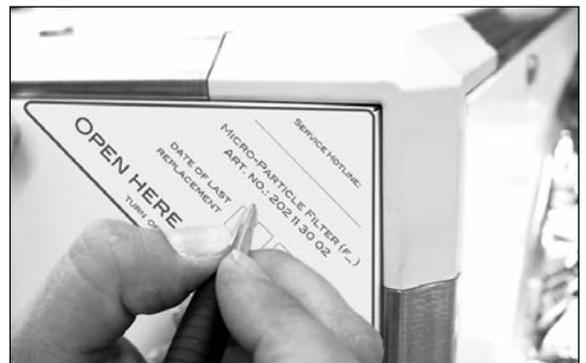
8. Remplissez l'étiquette de remplacement des filtres en inscrivant la date programmée du prochain remplacement des filtres. Cette date doit être inférieure à 3 ans à partir de la date courante et indiquée sur l'extérieur du panneau.
