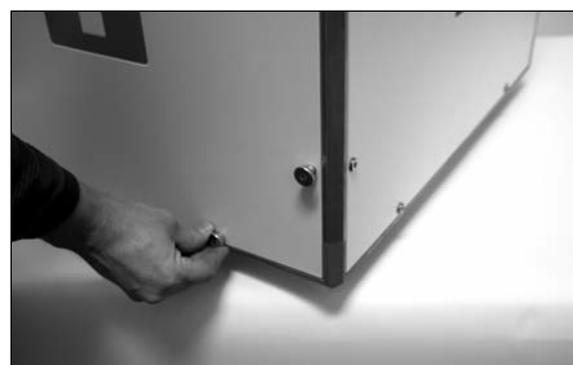
7. Installer le panneau d'accès aux filtres en utilisant les huit grandes vis à serrage manuel.
