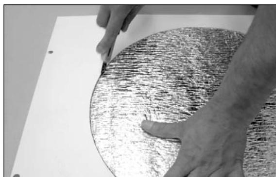
4. Remplacez l'isolation dans le panneau. Déposez le panneau sur une surface dure protégée. En utilisant une lame affûtée, découpez l'isolation le long de l'ouverture du panneau.
